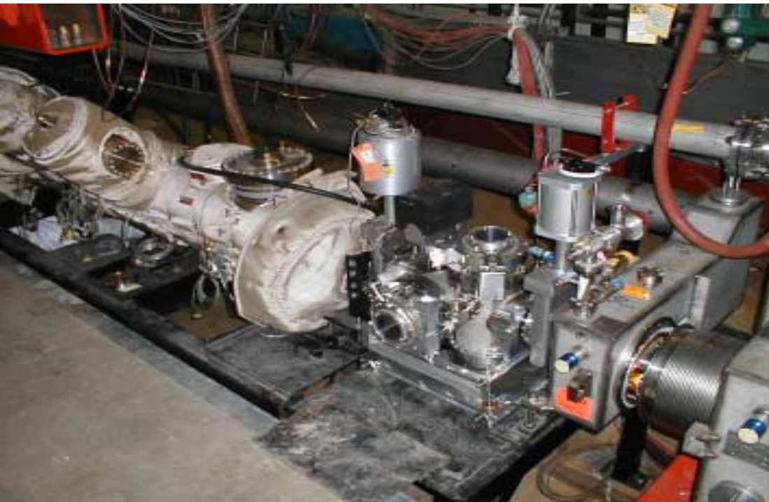
Um dos Roman Pots tipo Quadripolo junto do Separador no Tevatron
